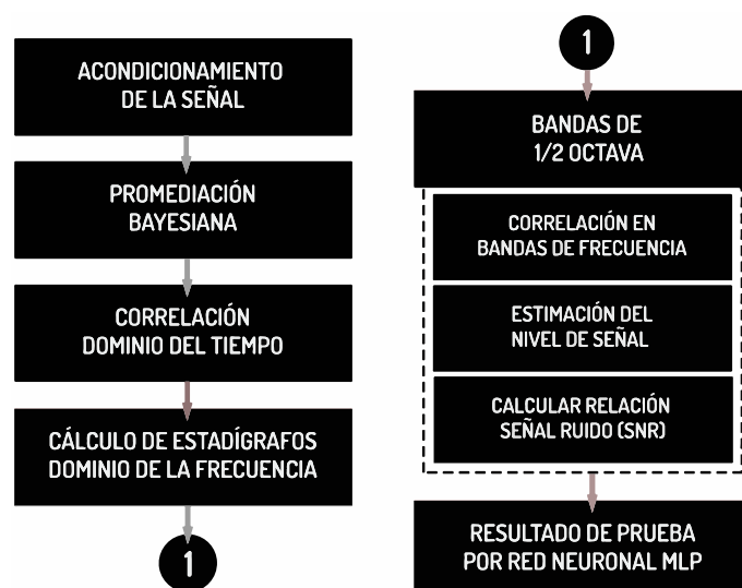
Fig. 3- Diagrama de flujo del método automático de EOAT basado en red neuronal MLP.
