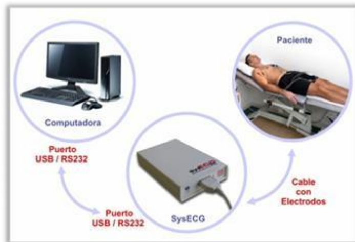
Fig. 1. Elementos involucrados en la ejecución del sistema.
