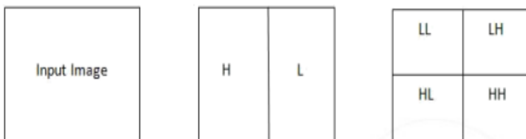
Fig. 5- Bandas de Wavelet después del primer nivel de descomposición. Fuente: (20)
