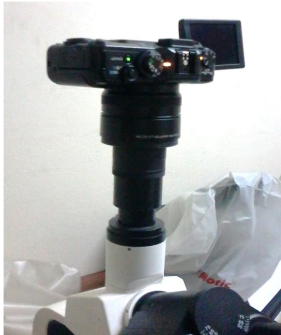
Fig. 3 - Cámara acoplada de forma fija al microscopio.
