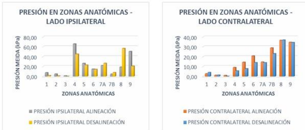
Fig 2. Comportamiento de la presión en las diferentes zonas anatómicas cuando la prótesis está alineada y en desalineación. En el lado ipsilateral la mayor presión se presenta en la zona 4, cuando la prótesis se encuentra alineada, teniendo cerca del 30 % de la presión total sobre el pie; en desalineación esta presión disminuye, llegando a estar cerca del 22 %. Cuando la prótesis se encuentra desalineada la mayor presión se ubica en la zona 8, donde soporta cerca del 28% de la presión total ejercida sobre el pie, este valor se ve alterado en alineación, pues disminuye hasta cerca del 9 %. Otra de las zonas más afectadas en desalineación es la zona 9, ya que pasa de soportar alrededor 22 % de la presión total al 9% en desalineación. En contralateral, las variaciones de presión de alineación a desalineación de la prótesis son menores a las mostradas por el lado ipsilateral, sin embargo las zonas más afectadas son 4, 5, 6 y 7B
