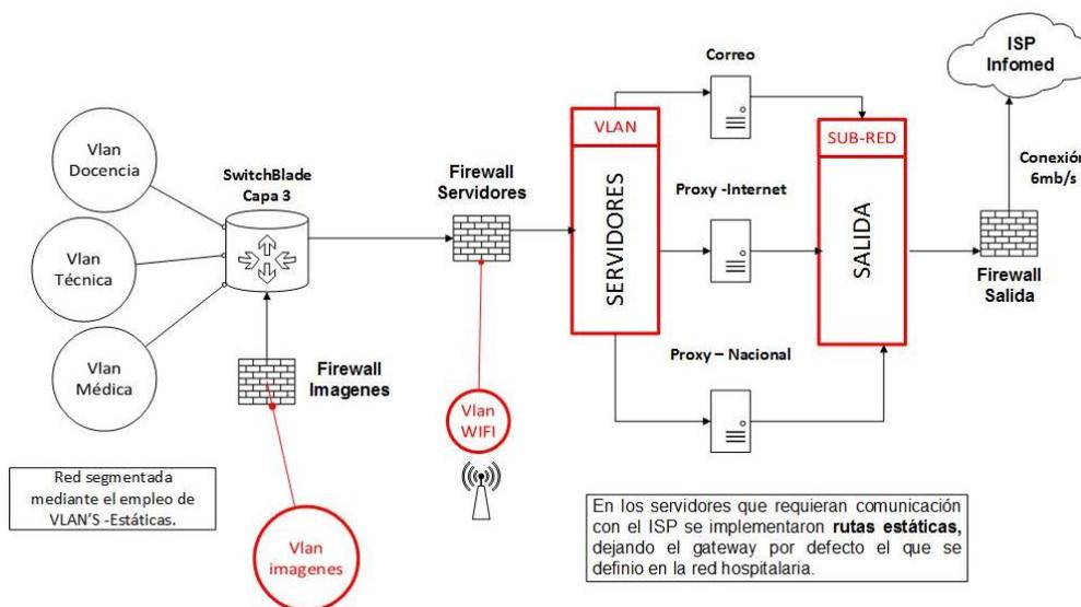
Fig. 2- Esquema lógico de la red del CIMEQ. Fuente: elaboración propia.
