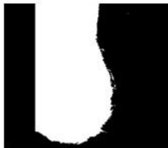
Fig. 5. Binarización con T=70
